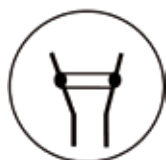
IEC/EN 60947-5-1 Contactos enclavados mecánicamente
