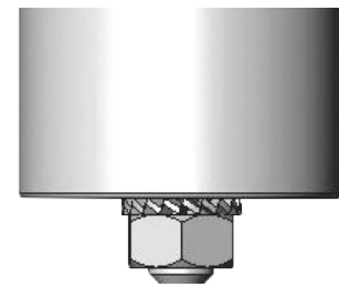
Fijación a través de tornillo M12 (tuerca y arandela dentada incluidas en la UCWT) 1)
